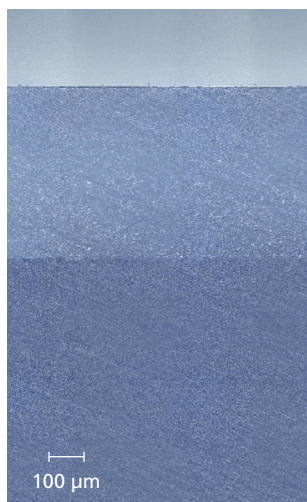
1 Oben: Lasergeschweißter PA6.6–GF20-Probekörper. Unten: Bruchbild nach Zugscherbelastung mit Versagen des Grundmaterials außerhalb des Schweißnahtbereichs. 2 Mikroskopische Analyse der Fügeebene ohne erkennbare Beschädigungen oder Wärmeeinflusszone.
