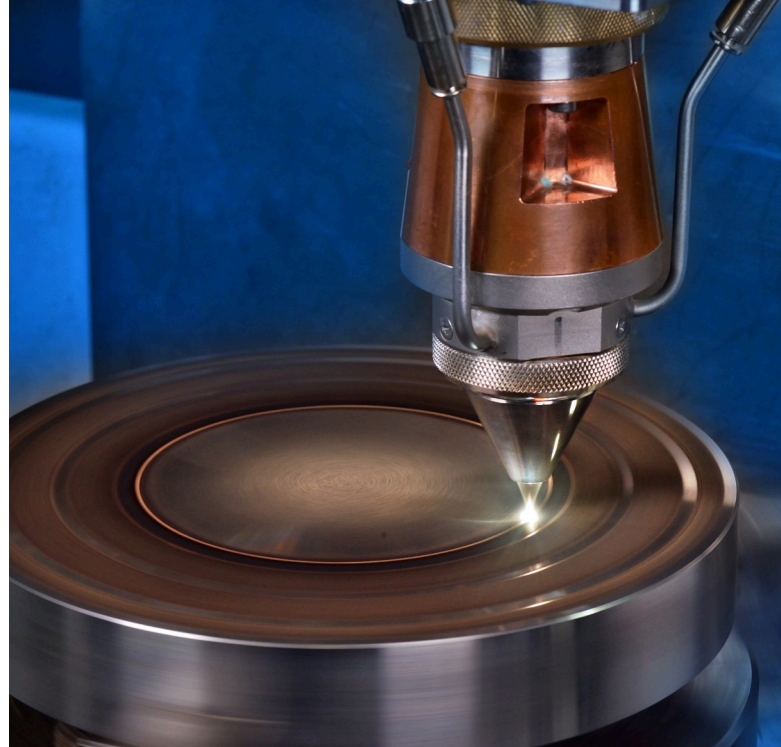
1 Plattenabschnitt mit CuSn10-Schicht. 2 CuSn10 EHLA-Prozess.
