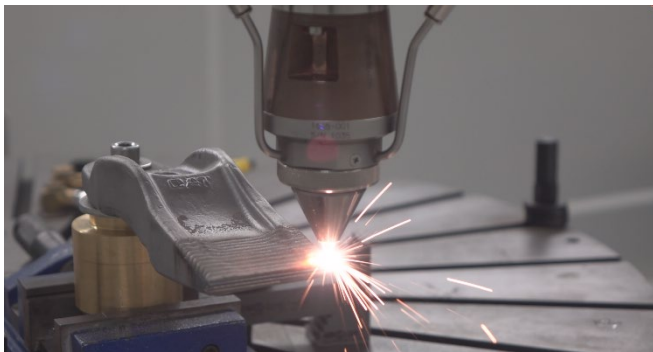
Bild 1: Beschichtung von Baggerzähnen mit Laserauftragschweißen (Laser Material Deposition, LMD). ©Fraunhofer ILT, Aachen.
