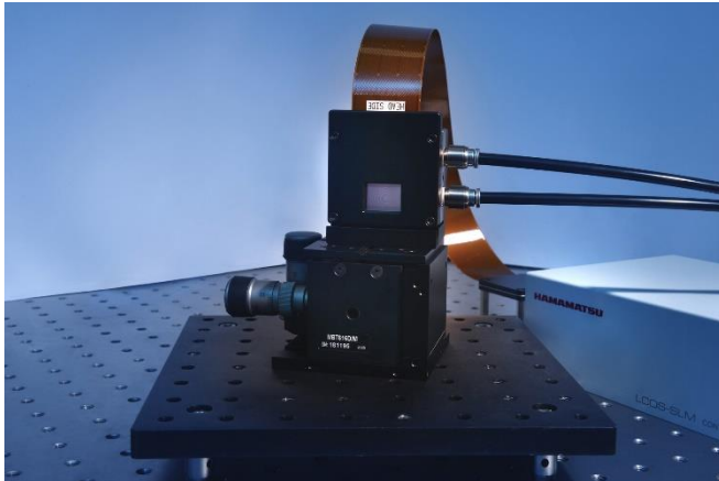
Bild 2a & 2b: Mit der aktuell im Aufbau befindlichen Anlage (oberes Bild) lassen sich mithilfe von LCoS-SLMs durch gezielte Krümmung der Phasenfront des Laserstrahls nahezu beliebige Strahlprofile (unteres Bild) im LPBF-Prozess erzeugen. © Fraunhofer ILT, Aachen.
