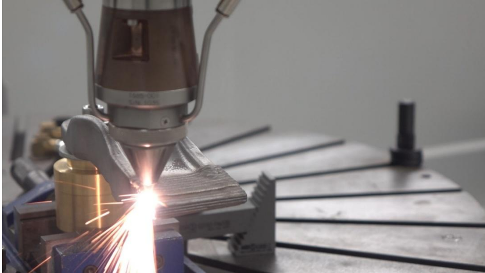
Abb. 4: Im Projekt AI-SLAM zeigen die Forschenden des Fraunhofer ILT gemeinsam mit internationalen Partnern, dass sich Beschichtungs- und Reparaturprozesse mithilfe von Sensorik und Künstlicher Intelligenz automatisieren lassen.
