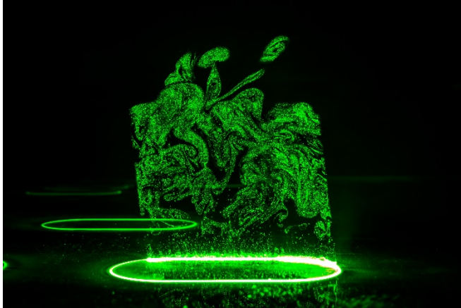
Bild 1: Strukturierungsprozess von Glas durch direkte Laserablation bei der Verwendung von ultrakurzen Laserpulsen. © Fraunhofer ILT, Aachen / Volker Lannert.
