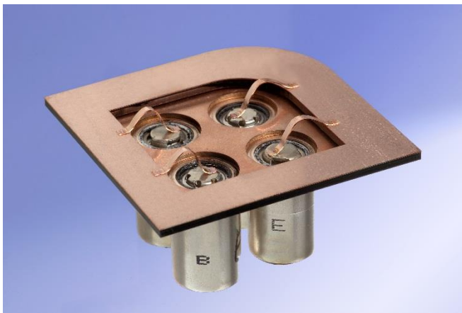
Bild 2: Kontaktierung von Batteriezellen Typ 18650 mittels Laserbonden. © Fraunhofer ILT, Aachen.
