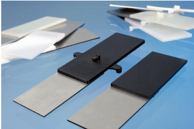
Bild 2: Im Spritzgussprozess hergestellte Hybridverbindung. © Fraunhofer ILT, Aachen.
