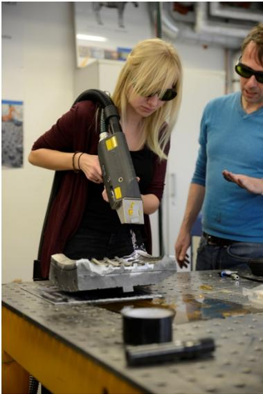
Bild 2: Hands on - Bei CleanLaser wurden Oberflächen mit dem Laser gereinigt. Bild: VDI Technologiezentrum
