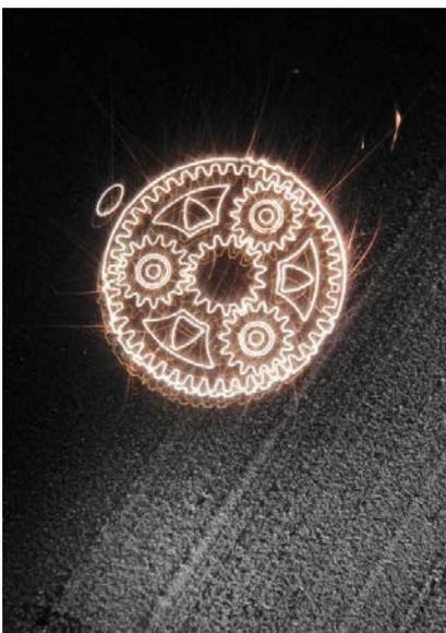
Bild 4: Langzeitbelichtung eines Planetengetriebes im Entstehungsprozess. In einem Metallpulverbett wird das Bauteil mit einem Laser Schicht für Schicht aufgebaut. Bild: Fraunhofer ILT, Aachen
