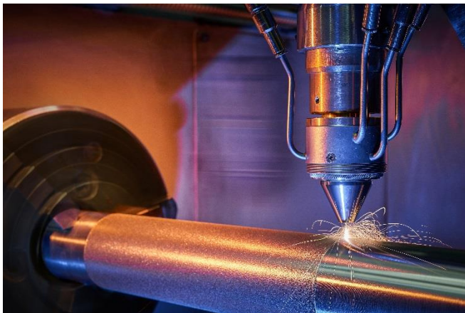
Bild 1: Demonstrationsobjekt: Ein Video demonstriert auf Internationalen Luft- und Raumfahrttausstellung ILA Berlin, wie schnell, präzise und effizient das Laserauftragschweißen mit EHLA funktioniert. © Fraunhofer ILT, Aachen / Volker Lannert.
