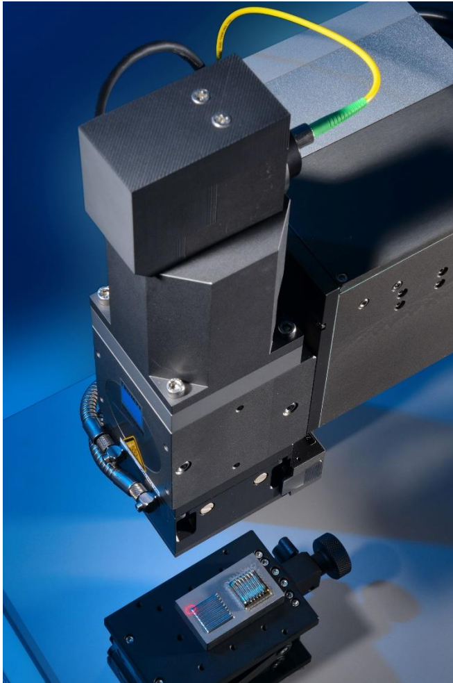
Bild 2: Laserbearbeitungsoptik mit »bd-1«-Sensorik und kompakter Messstrahlableitung für Inline-Geometriemessungen. © Fraunhofer ILT, Aachen.
