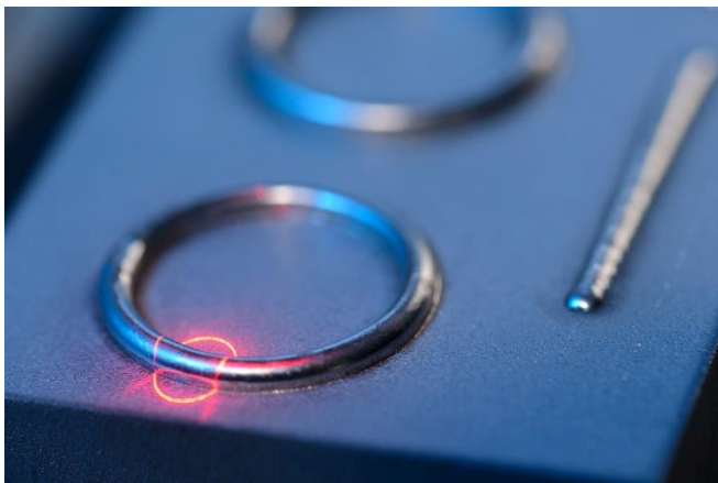
Bild 1: Umlaufender Messpunkt zur Inline-Messung aufgetragener Spurhöhen beim Laserauftragschweißen. © Fraunhofer ILT, Aachen.
