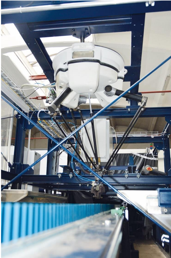
Bild 3: Die Pilotanlage für das laserbasierte Recycling, die im Projekt PLUS entstand, eignet sich z. B. für die automatische Verarbeitung von Schnellarbeitsstählen (High Speed Steels). © Cronimet Ferroleg. GmbH, Karlsruhe.
