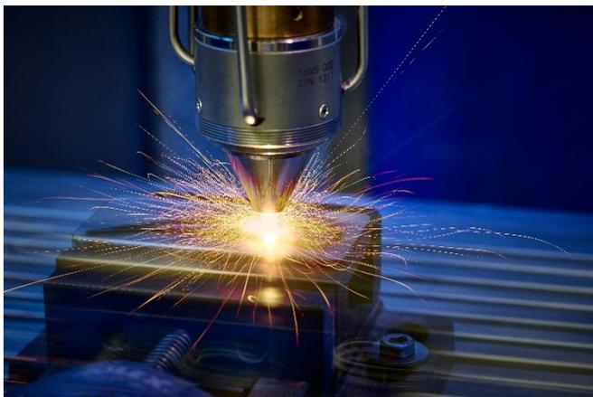
**Bild 3: Hochproduktiven 3D-Druck ermöglicht der Einsatz der EHLA-Technik in einer Parallelkinematik und in einem modifizierten 5-Achs-CNC-Prototypen. Mit der Parallelkinematik ließen sich z. B. erste Komponenten aus Edelstahl 316L mit 1,7 kg/h bei einem Vorschub von 40 m/min. schnell und zuverlässig drucken.**
