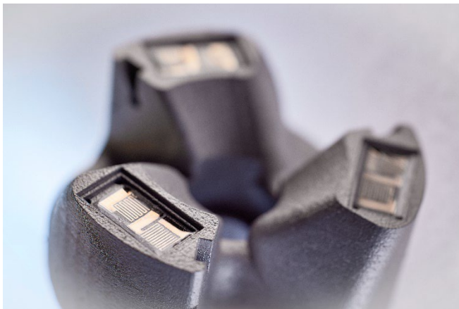
Bild 2a: In einem Messerkopf wurden während des Druckprozesses Dehnungsmessstreifen integriert. Vorher: Der LPBF-Druckprozess wird unterbrochen und die ebenfalls gedruckten Dehnungsmessstreifen eingepasst. © Fraunhofer ILT, Aachen.
