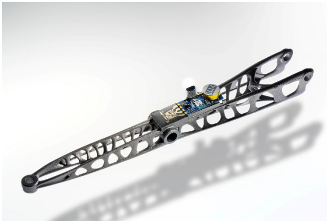
Bild 1: Der PKW Querlenker mit aufgedrucktem Kraftsensor liefert zu jedem beliebigen Zeitpunkt die im Einsatz wirkenden Kräfte und registriert kleinste Risse, die auftreten, bevor ein Defekt entsteht. © Fraunhofer ILT, Aachen.
