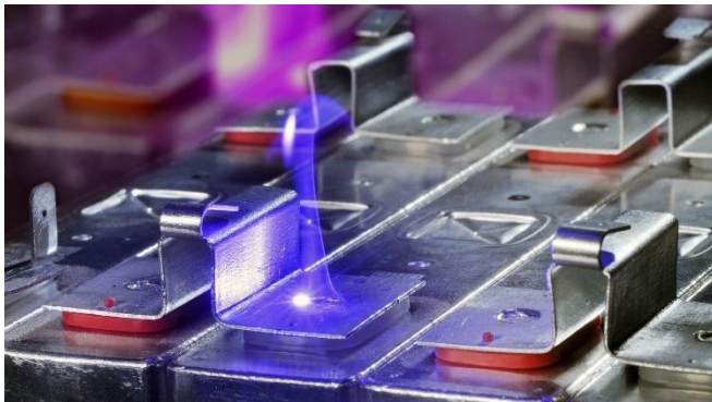
Bild 4: Laserstrahlschweißen von Batteriezellen mit blauem Laser. © Fraunhofer ILT, Aachen.
