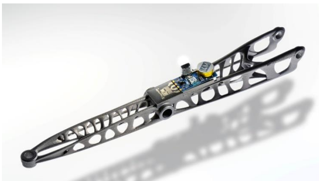
Bild 5: Der PKW Querlenker mit aufgedrucktem Kraftsensor liefert zu jedem beliebigen Zeitpunkt die im Einsatz wirkenden Kräfte und registriert kleinste Risse, die auftreten, bevor ein Defekt entsteht. © Fraunhofer ILT, Aachen.
