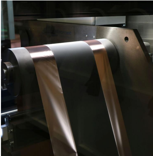
Bild 2: Die Lasertrocknung im Rolle- zu-Rolle-Verfahren macht die Serienproduktion von Lithium-Ionen-Batterien deutlich nachhaltiger und wirtschaftlicher. © PEM RWTH Aachen University.
