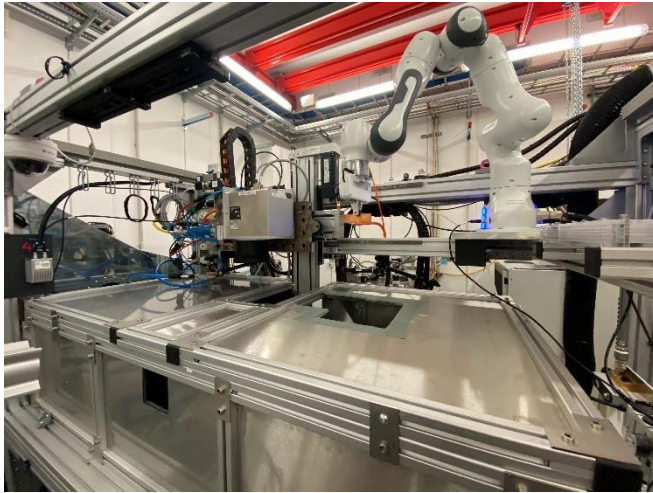
Bild 2: Versuchsaufbau zur Durchführung der Phasenkontrastvideographie an Beamline P61A bei DESY Petra III. © RWTH Aachen – Lehrstuhl für Lasertechnik.
