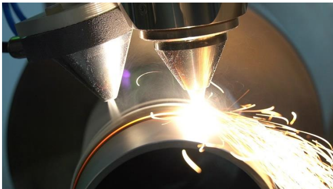
Bild 3: Ein neues Laserkombinationsverfahren ermöglicht PFAS-freie Verbundschichten aus Metall und dem Hochleistungskunststoff PEEK für zusätzliche Anti- Haft-, Gleit- oder Korrosionsschutzfunktionen auf Metallbauteilen. © Fraunhofer ILT, Aachen.
