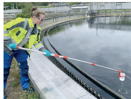
Stichprobenartige manuelle Probenentnahme soll durch laserbasierte Tauchsonde des Fraunhofer ILT ergänzt bzw. langfristig ersetzt werden, © Wasserverband Eifel-Rur.
